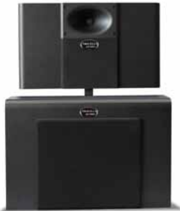
Fronthögtalare: Procella Audio P610. 3-vägs system med aktiv delning till 10-tums bas och passivt mellan 6.5 tum mellanregister och kompressordriver med waveguide.
